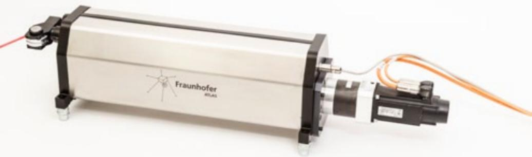
*Winde des Seilroboters IPAnema 3*
